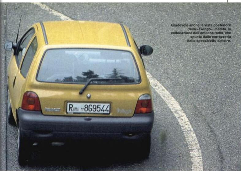
Gradevole anche la vista posteriore della «Twingo». Inedita la collocazione dell'antenna radio, che spunta dalla carrozzeria dello specchio sinistro.
